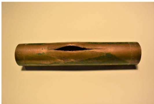
Abb. 1: Rohrbruch — Kupferrohr geplatzt
